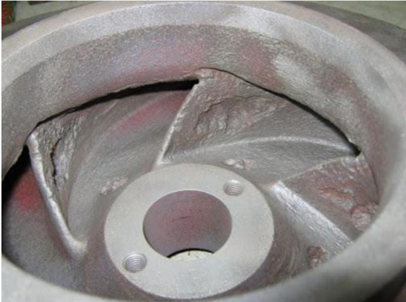
La cavitation est caractérisée par l'apparition de bulles de vide d'air/vapeur d'eau dans les zones en dépression des parties en mouvement. Lorsque ces bulles se «referment» une onde de choc de plusieurs centaines de bars vient percuter le matériau de la roue et arrache des particules → dégradation de surface, pouvant amener à la destruction complète de la pompe à terme.
